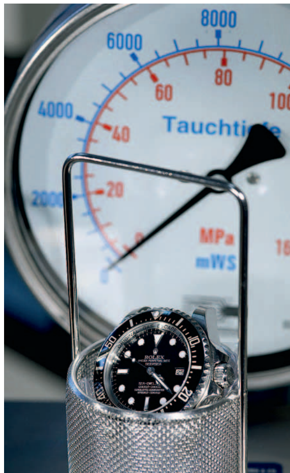
Simulierte Reise in die Tiefsee: Wir setzten die Deepsea in diesem mit Wasser gefüllten Gerät einem Druck aus, der 3900 Meter Wassertiefe entspricht. Sie überstand die Tortur ohne Schäden oder Wassereintrich und lief auch nach dem Test genauso präzise wie davor
